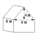
**129.** Двускатную крышу дома, имеющего в основании прямоугольник (см. рис.), необходимо полностью покрыть рубероидом. Высота крыши равна 4 м, длины стен дома равны 6 м и 8 м. Найдите, сколько рубероида (в квадратных метрах) нужно для покрытия этой крыши, если скаты крыши равны.
